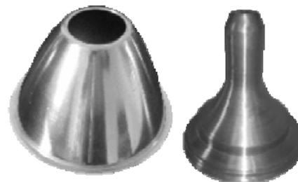
Fig.05. Exemples de pièces repoussées
