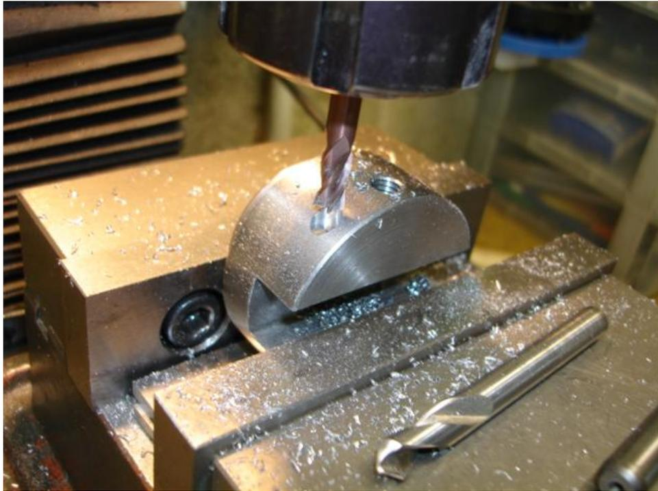
**Fig.17. Le Perçage**
